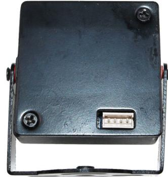
YDS-USB-0394 V1 ist ein 2,1-MP-USB-Kameramodul mit festem Fokus, das auf einem 1/2,7-Zoll-AR0230-Bildsensor basiert. Es liefert ultrascharfe Hochgeschwindigkeitsbilder mit 2K-Auflösung.
